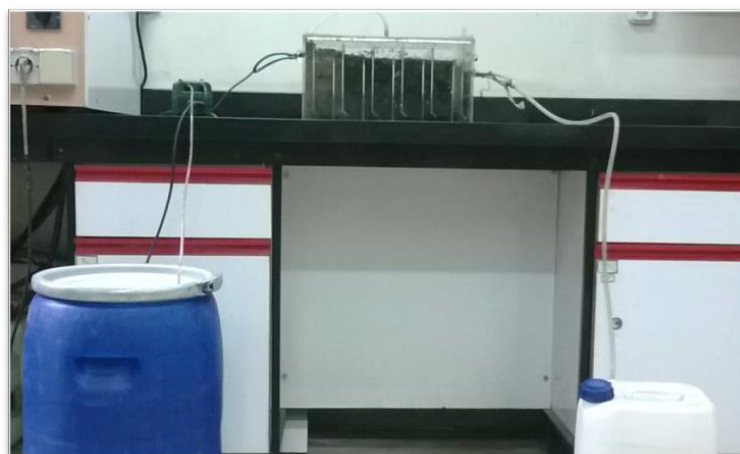
شکل ۱- شماتیک (الف) و سیستم واقعی (ب) AnBR مورد استفاده در این مطالعه
