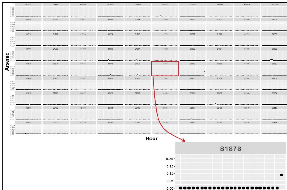
شکل ۴- نمودار تزریق آلودگی برای ۹۰ نقطه شبکه توزیع آب تحت پوشش مخزن ۴ در ۲۴ ساعت شبانه روز
