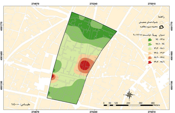
شکل ۳- توزیع فضایی شاخص L_{eq} در روز دوشنبه ۱۳۹۰/۱۲/۱۵
