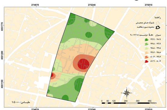
شکل ۴- توزیع فضایی شاخص L_{dn} در روز دوشنبه ۱۳۹۰/۱۲/۱۵
