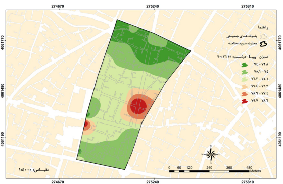
شکل ۳- توزیع فضایی شاخص L_{eq} در روز دوشنبه ۱۳۹۰/۱۲/۱۵
