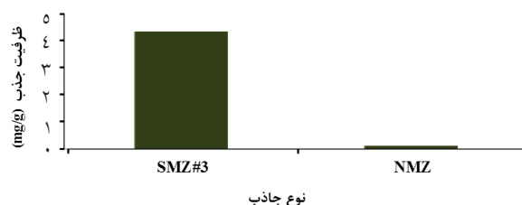
نمودار ۱: میزان ظرفیت جذب رنگ راکتیو قرمز ۱۲۰ بوسیله زئولیت خام (NMZ) و اصلاح شده (SMZ) (دوز جاذب ۱g در ۱۰۰ mL، pH=۵/۶)
