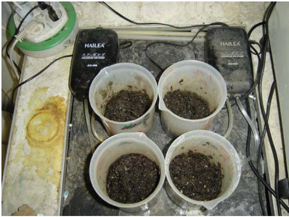
شکل ۱- راکتورهای بیولوژیکی کمپوست درون محفظه‌ای مورد استفاده
