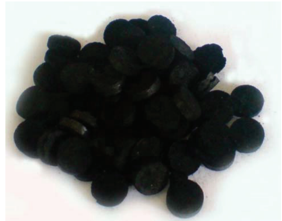
شکل ۱ تصویر نانولوله‌های کربنی شکل‌دهی شده
