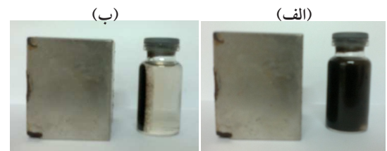
شکل ۱- نحوه جداسازی نانو ذرات آهن مغناطیسی سنتز شده توسط آهنربا، (الف) قبل از جداسازی، (ب) بعد از جداسازی
