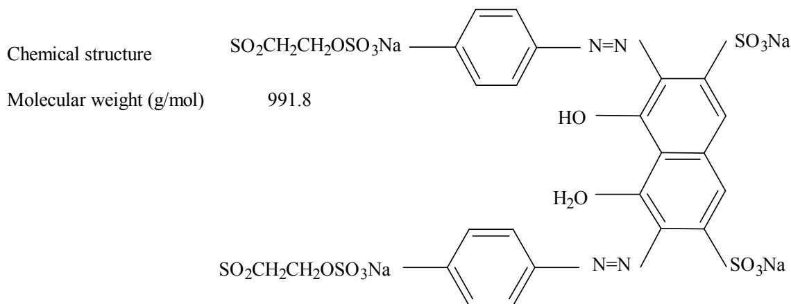
شکل ۱: ساختار رنگ راکتیو بلک ۵ با فرمول شیمیایی (C_{26}H_{21}Na_4N_5O_{19}S_6)
