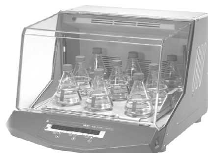
شکل ۱: هم زن مجهز به انکوباتور و راکتورهای آزمایشی
