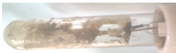
شکل ۶: نمایی از رسوب تشکیل شده بر سطح کوارتز لامپ های فشار متوسط و کم فشار UV
