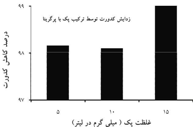
شکل ۳: درصد کاهش کدورت توسط ترکیب پرگرینا با آلوم و پلی آلومینیم کلراید (پک)
