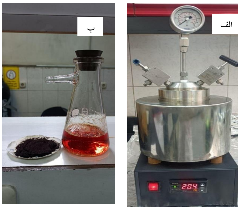
شکل ۱- راکتور مورد استفاده در فرایند HTC، (الف) در حال راهبری و (ب) محصولات تولیدی (هیدروچار و آب فرایندی)
