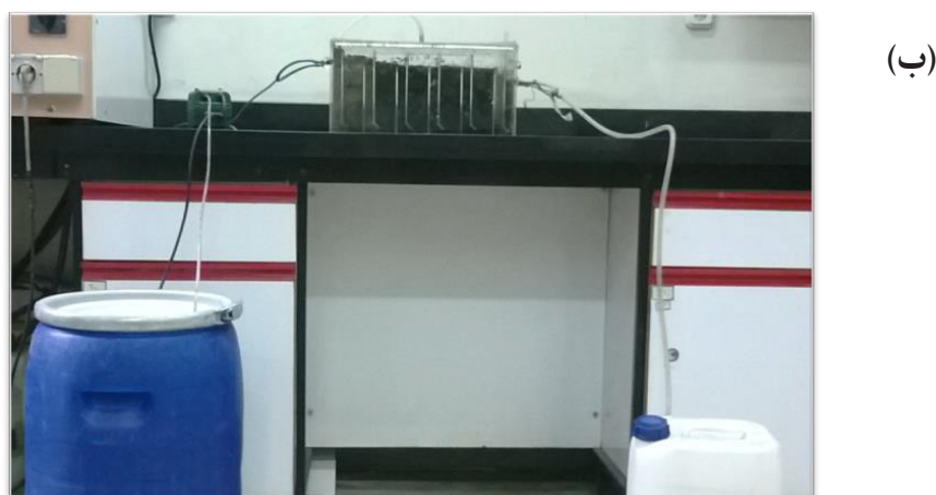
شکل ۱- شماتیک (الف) و سیستم واقعی (ب) AnBR مورد استفاده در این مطالعه
