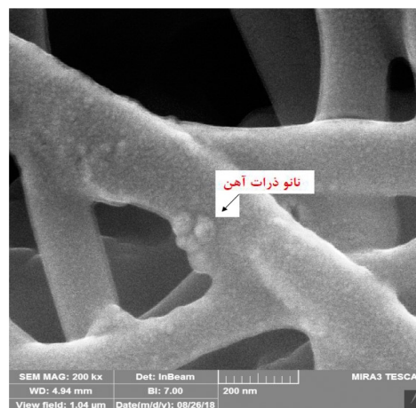
شکل ۱- تصویر میکروسکوپ الکترونی روبشی نانو الیاف مغناطیسی کیتوسان- نانو زیرکونیوم
