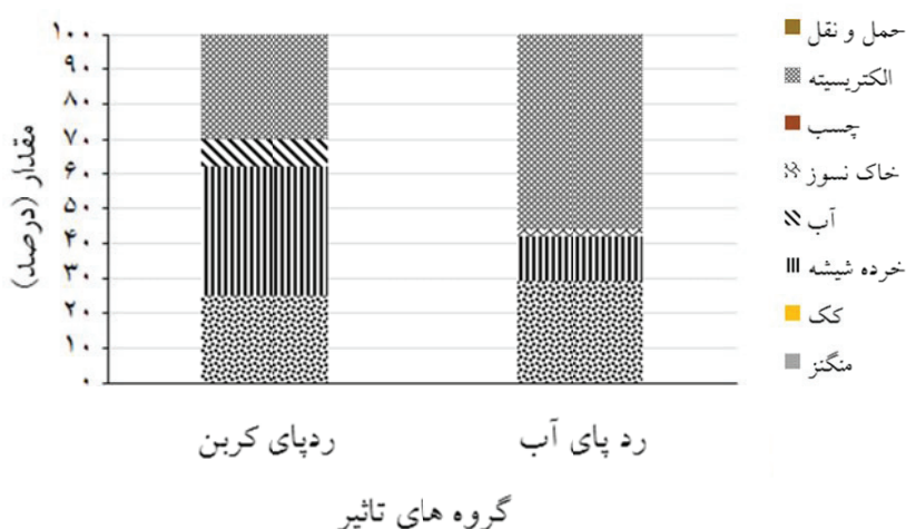
نمودار ۱- نتایج رد پای کربن و آب فرایند تولید فولاد از آهن قراضه
