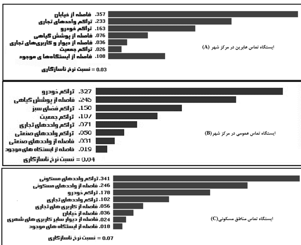
شکل ۱- اهمیت معیارها و نسبت سازگاری جهت جانمایی ایستگاه‌های سنجش کیفیت هوا
