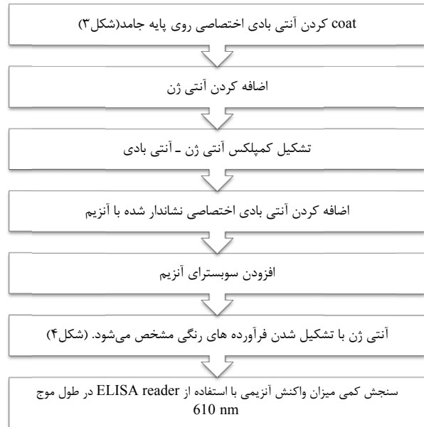
شکل ۲- مراحل کلی سنجش نشانگرهای زیستی با استفاده از روش ELISA (Enzyme-linked immunosorbent assay)
