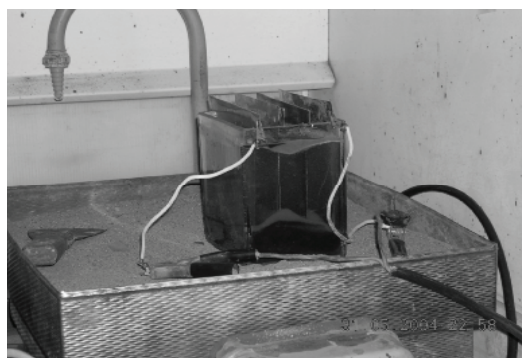
شکل ۴: راکتور الکتروشیمیایی در حال حذف سیانید از پساب آبکاری
