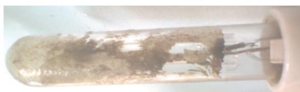
شکل ۶: نمایی از رسوب تشکیل شده بر سطح کوارتز لامپ های فشار متوسط و کم فشار UV
