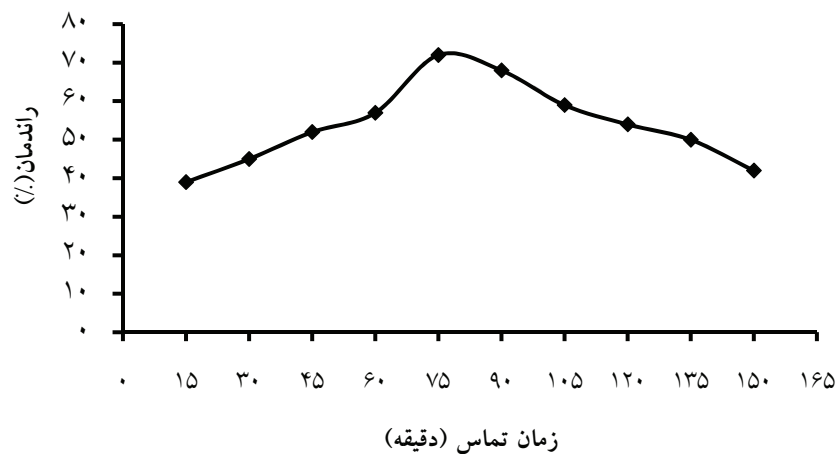
شکل ۳: درصد حذف COD در زمان تماس های مختلف (شرایط آزمایش: \text{pH} = 3 و H_2O_2/Fe^{2+} = \text{Fixed} )
