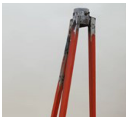
شکل ۱- پایه طراحی شده و فیلتر جهت نمونه‌گیری از ذرات گرد و غبار به مدت 6\text{ h}
