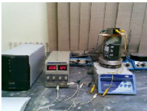
شکل ۱: راکتور انعقاد الکتریکی مورد استفاده در تحقیق حاضر
